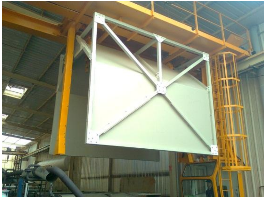
Chemikalienbeständig: Foamlite® ist für den Einsatz im chemischen Anlagen- und Behälterbau zugeschnitten, wie beispielsweise als mobile Abdeckhaube in einer Galvanikanlage (Foto: Europe Environnement, ASPACH LE HAUT, FRANCE, www.europe-environnement.com )
